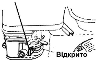
Паливний важіль (рисунок 2) відкриває і закриває надходження палива з баку в карбюратор. Для роботи двигуна паливний важіль повинен бути встановлений у положення «Відкрито».
