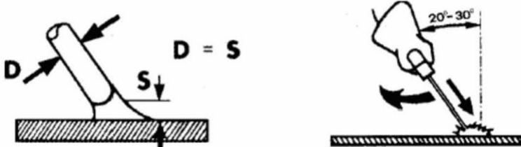
Завершуючи процес зварювання, слід правильно заварити кратер, який утворюється в процесі зварювальних робіт від контакту електрода зі зварюваної поверхнею. Це необхідно зробити, щоб уникнути можливого виникнення тріщин у зварювальному шву. Не слід обривати дугу, різко відводячи електрод від виробу. Необхідно припинити переміщення електрода і повільно подовжити дугу до її обриву (при цьому електродний метал розплавиться і заповнить кратер).
